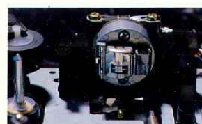
Rotating heads für beste Azimuteinstellung.
