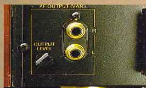
Oben: Übersichtliches Fluoreszenz-Display. Unten: Regelbarer NF-Ausgang.
